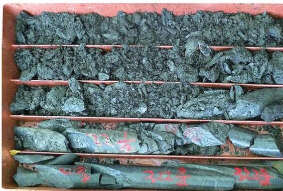
2可以看出高地锰矿勘查区上部娄山关组、石冷水组、高台组、清虚洞组的主要岩石为白云岩,尤其是娄山关组白云岩夹杂硅质团块、碎屑颗粒,容易出现掉块卡钻。另外,目前主流钻杆都是带接头的,而钻杆接头外径要比钻杆中部外径大3 mm左右,这就给掉块卡钻提供了较大的可能。
