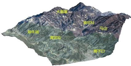
图 4 采用高分辨率航天遥感图像纹理映射的地表模型
