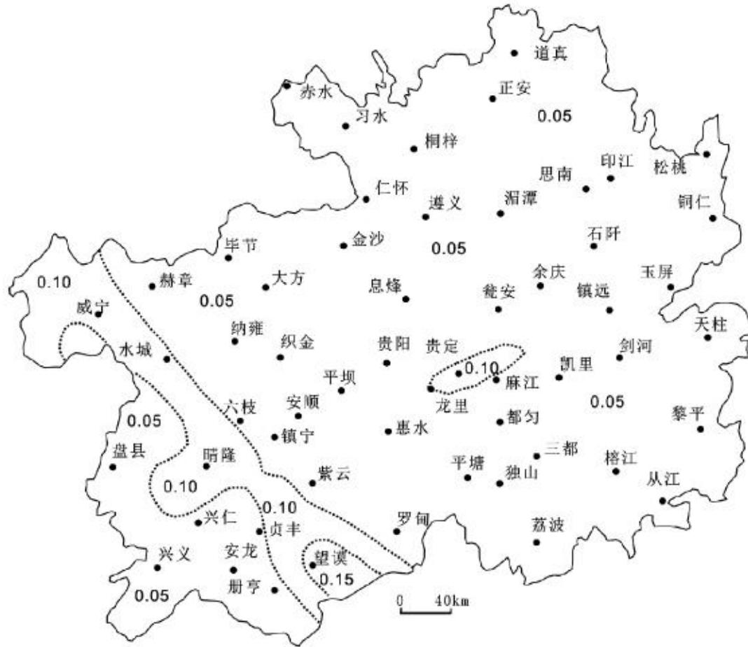
图6 第五代贵州省地震动参数区划图(0.05、0.10、0.15表示地震动参数值)
