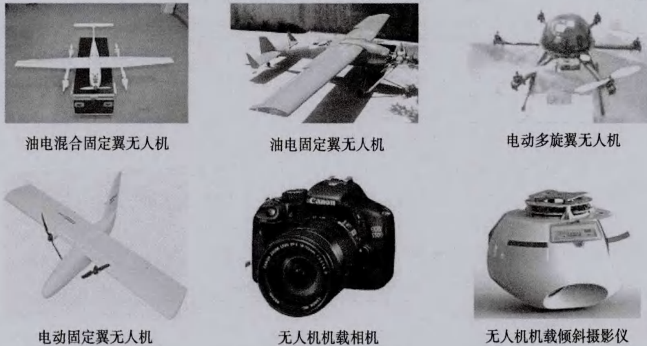
图1 无人机类型及航摄设备
