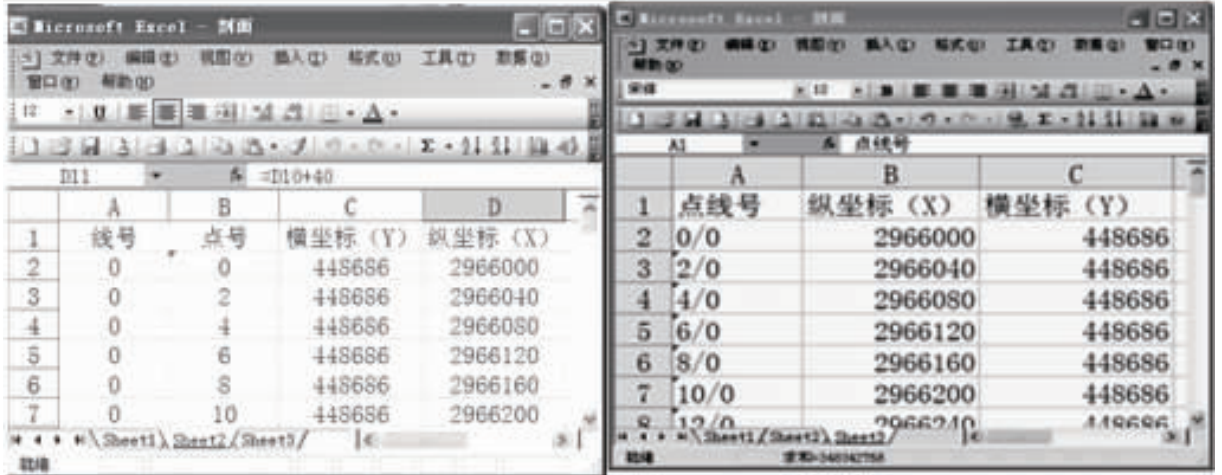
图3 物探测网设计数据准备(左为物探设计结构数据、右为测量结构数据)
